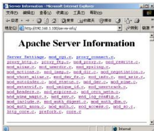
图 7-6 访问控制配置测试—在被允许的主机上访问
