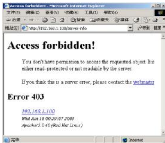
图 7-7 访问控制配置测试—在被拒绝的主机上访问
